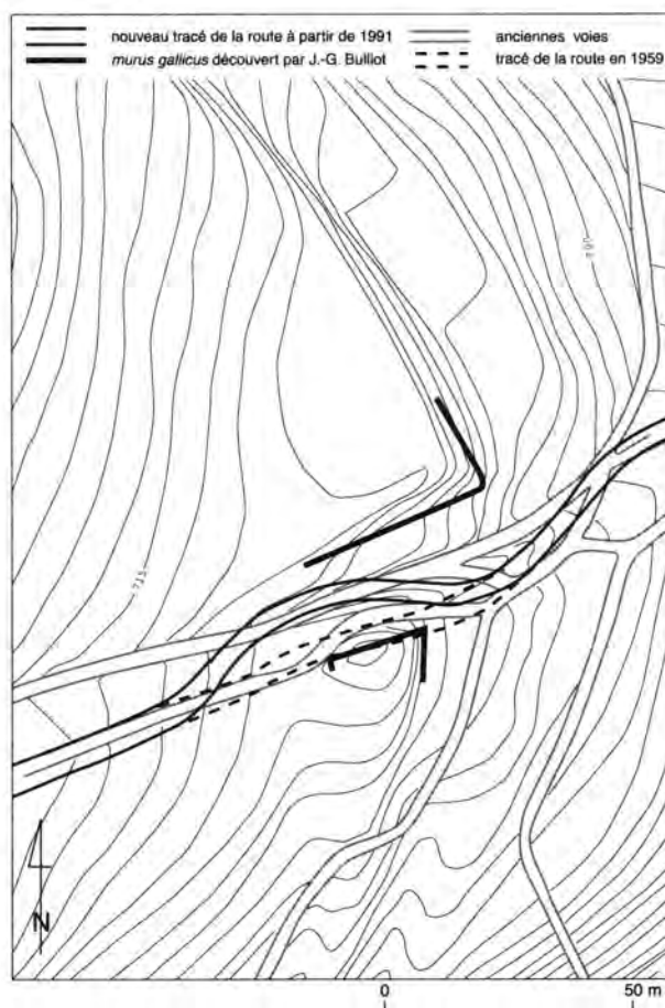
6. La Porte du Rebout, topographie restituée avant le tracé de la route moderne en 1959 et emplacements successifs de la route moderne. Équidistance des courbes : 1 m.
