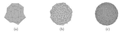
Fig. 1. Inclusion elements for three different sizes of meshing: (a) 3000 elements; (b) 32 000 elements; (c) 335 000 elements. Fig. 1. Eléments de l'inclusion pour trois tailles de maille différentes : (a) 3000 éléments ; (b) 32 000 éléments ; (c) 335 000 éléments.
