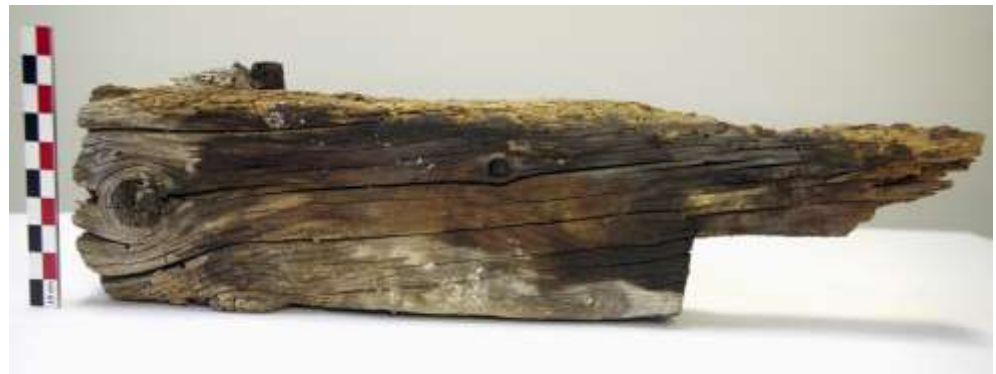
Fig. 16 : Partie prélevée du tirant T7-8
