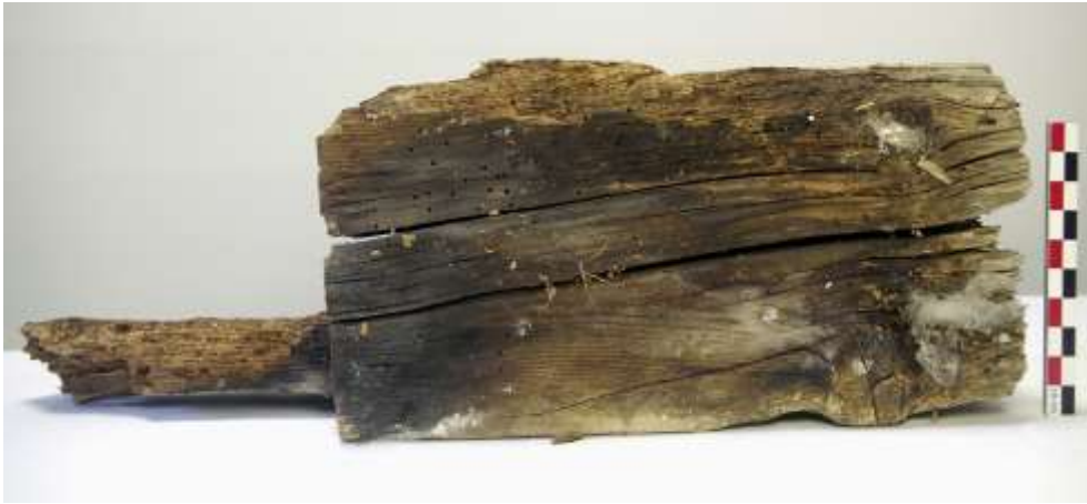
Fig. 16 : Partie prélevée du tirant T7-8
