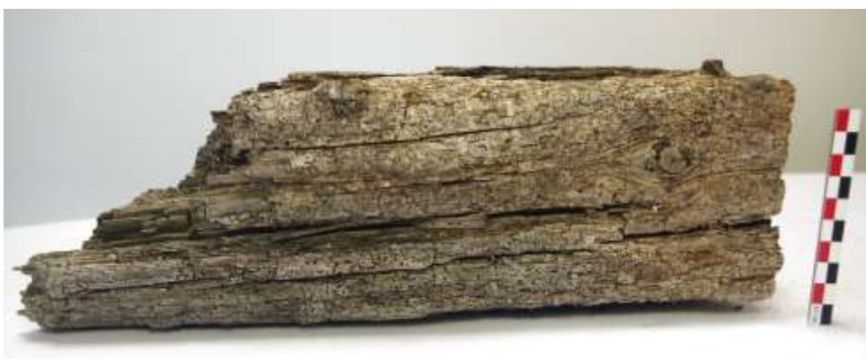
Fig. 12 : Partie découpée du tirant T1-2
