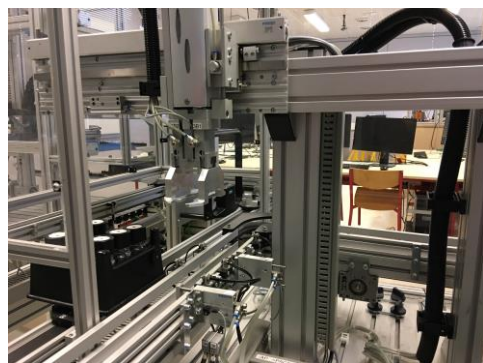
Figure 5. STATION TRANSFERT VERS LE CONVOYEUR CENTRAL
