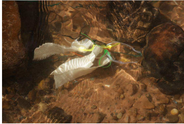
Figure 34 - Bandes de coton déployées dans un cours d'eau.
