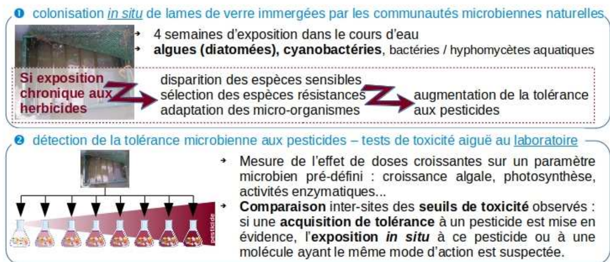
Figure 24 - Représentation schématique des deux étapes de mise en œuvre de l'outil PICT.
