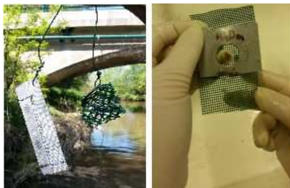
Figure 35 - Substrats artificiels pour mesurer la décomposition microbienne.
