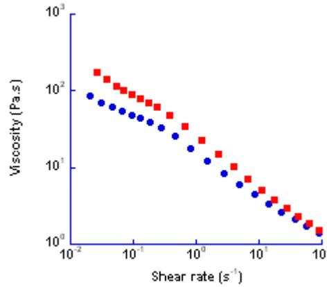
FIG. 4 – Comparaisons des évolutions des viscosités dynamiques en fonction du taux de cisaillement pour des émulsions obtenues après 18 minutes d'émulsification dans le MDB-CUVE (carrés) et le MDB-CONT (cercles).
