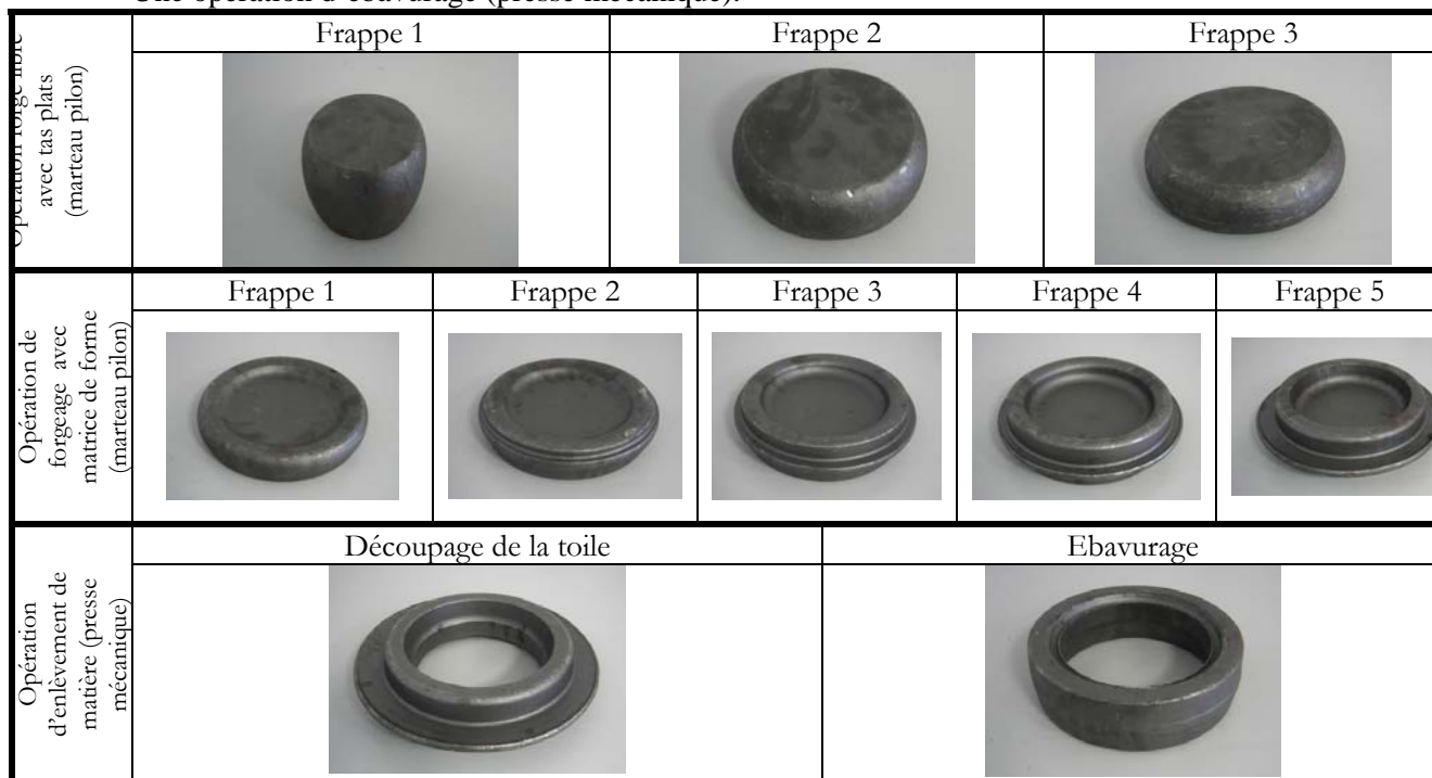
FIG. 2 – Evolution de la forme du brut de forge après les différentes opérations et les différentes frappes
