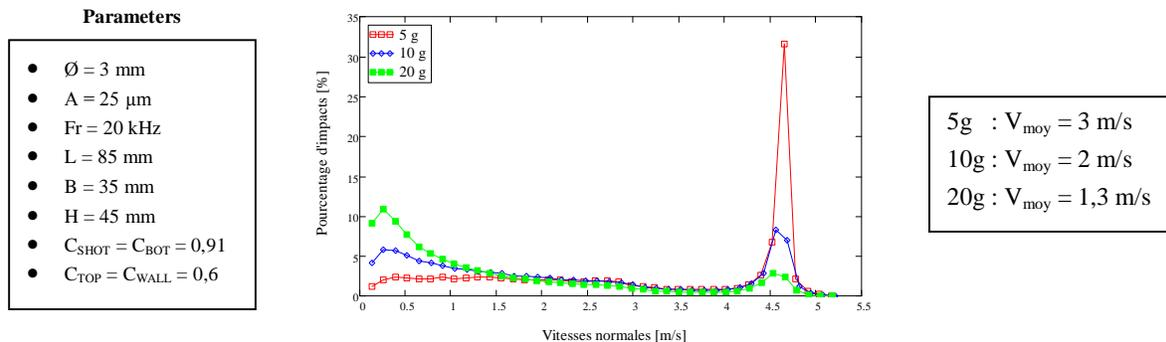
FIG. 2 : Distribution des vitesses normales d'impact au niveau du spécimen grenailé, pour différentes quantités de billes. (□□□) 5g = 45 billes, (◇◇◇) 10g = 90 billes, (■ ■ ■) 20g = 181 billes.
