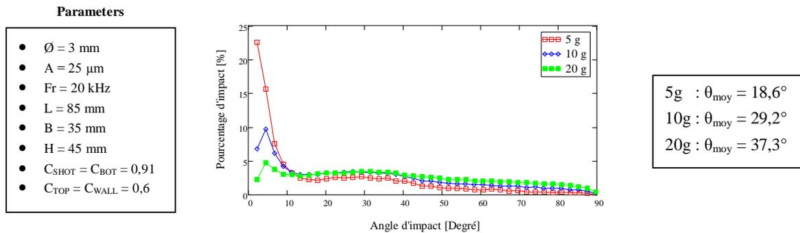
FIG. 3: **a)** Distribution des angles d'impact au niveau du spécimen grenailé, pour trois quantités de billes. (□□□) 5g = 45 billes, (◇◇◇) 10g = 90 billes, (■ ■ ■) 20g = 181 billes.
