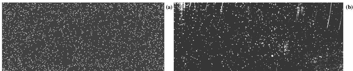
FIG. 7: Distribution des points d'impact sur le spécimen permettant de remonter à son taux de recouvrement R. a) Taux de recouvrement numérique du spécimen  $R = 7,3 \%$ . b) Taux de recouvrement expérimental du spécimen  $R = 4,3 \%$ .
