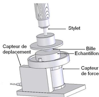
FIG. 1 : machine d'impact
