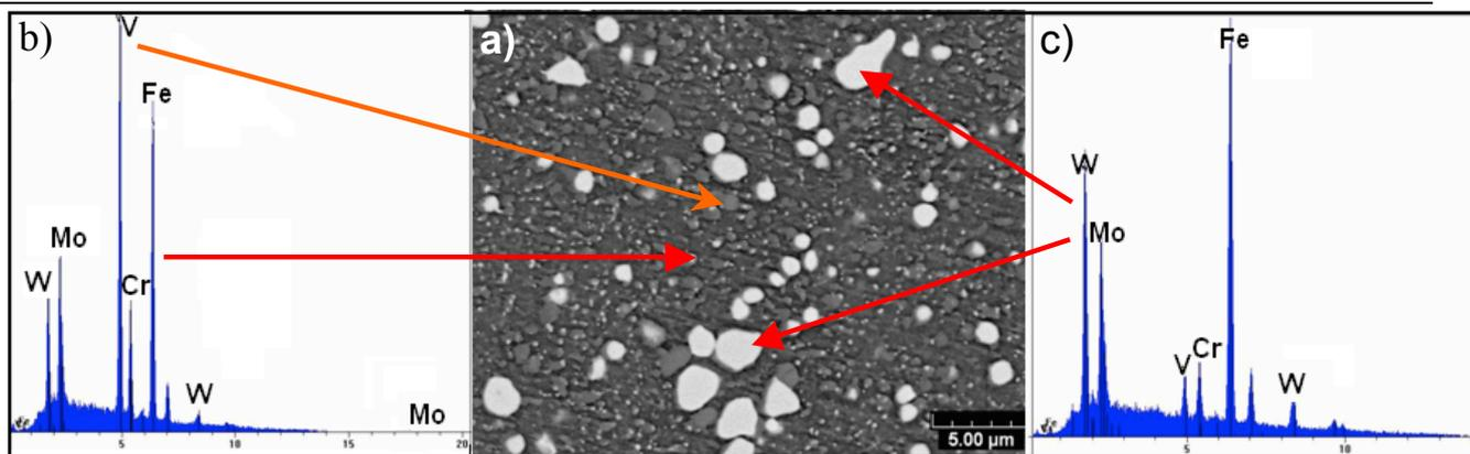
FIG. 5: a) Micrographie obtenue par MEB sur un substrat M2 non traité, (b, C) Analyses EDS des deux populations de carbures.
