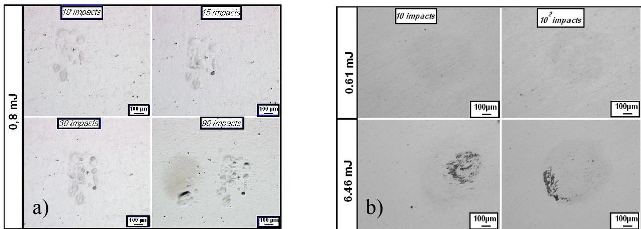
FIG. 2 : a) Evolution du phénomène de cloquage observé sur un film de CrN (substrat M2 non traité) en fonction nombre et de l'énergie d'impact. b) Endommagement observé sur un film de CrN (substrat M2 traité) en fonction nombre d'impacts pour une énergie de 0,61 mJ et 6,64 mJ
