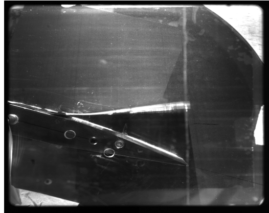
FIGURE 2 – Image du volet poreux lorsqu'il est activé ( \ell/c = 0.5 , Re = 1.6 \times 10^5 ). On remarque que le volet oscille autour d'une position d'équilibre (effet de flou).
