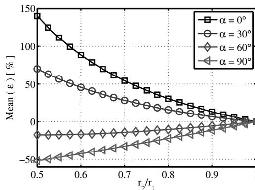
FIGURE 4 – Écart relatif  $\varepsilon$  en fonction du rapport  $r_2/r_1$  de l'ellipse et de l'angle d'inclinaison  $\alpha$  avec la direction de l'onde incidente.
