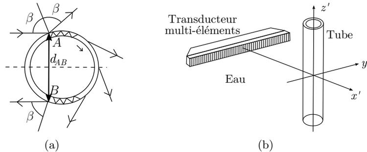
FIGURE 1 – Illustration sur une coque circulaire, d'après [5]. (a) Génération et rayonnement des ondes circumférentielles, (b) dispositif de mesure.
