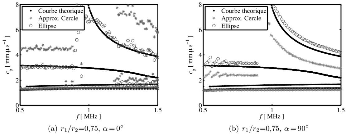
FIGURE 6 – Courbes de dispersion des ondes circumférentielles autour d’une coque elliptique. En noir : modes de Lamb théoriques dans une plaque chargée d’eau sur une de ses faces et d’air sur l’autre. En \* : approximation de cercle (Eq. (10)), et en  $\circ$  : ellipse avec les relations (8) et (9).
