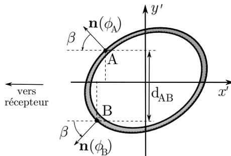
FIGURE 3 – Points d'émergence A et B d'une onde circonférentielle dans une coque elliptique vue par un récepteur situé loin de l'objet.
