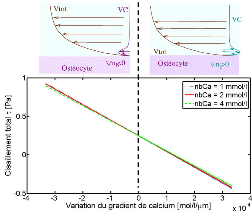
FIGURE 3 – Cisaillement dû à l'écoulement du fluide interstitiel et ressenti par les ostéocytes pour différents gradients et différentes concentrations de calcium.
