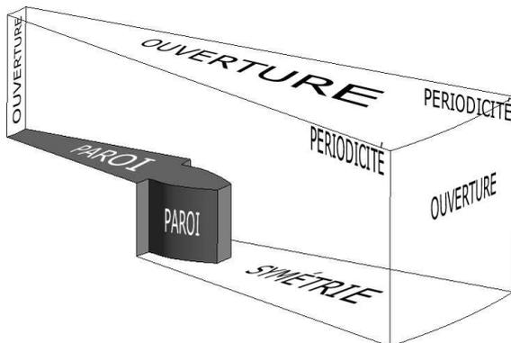
FIG. 1 – Schéma d'un domaine de calculs et conditions limites.
