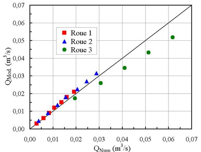
FIG. 5 – Comparaison des débits modélisés avec le coefficient moyen  $\bar{\lambda}$  et ceux estimés numériquement.
