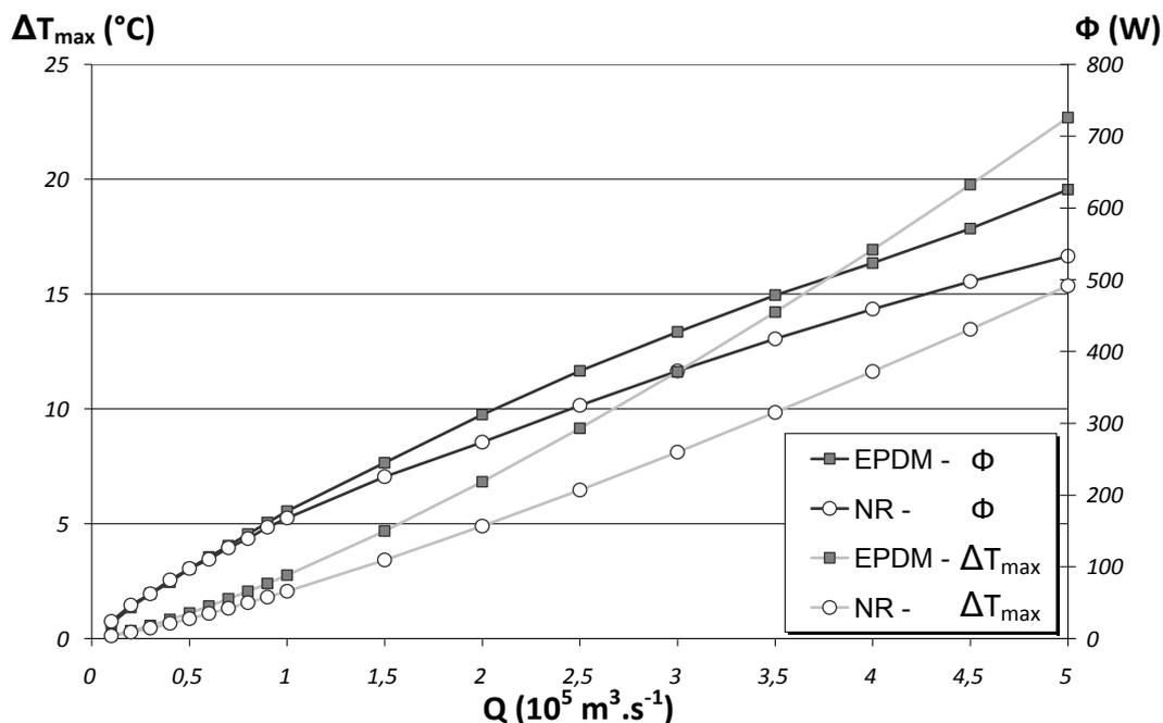
FIG. 3 – Influence du débit matière sur les conditions d'écoulement pour les deux mélanges : EPDM et NR
