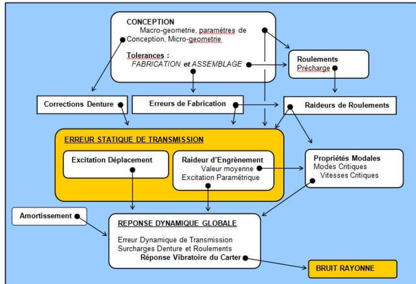
FIG. 1 – Principaux mécanismes gouvernant le comportement vibroacoustique d'une boîte de vitesses induit par l'erreur statique de transmission (d'après [3]).
