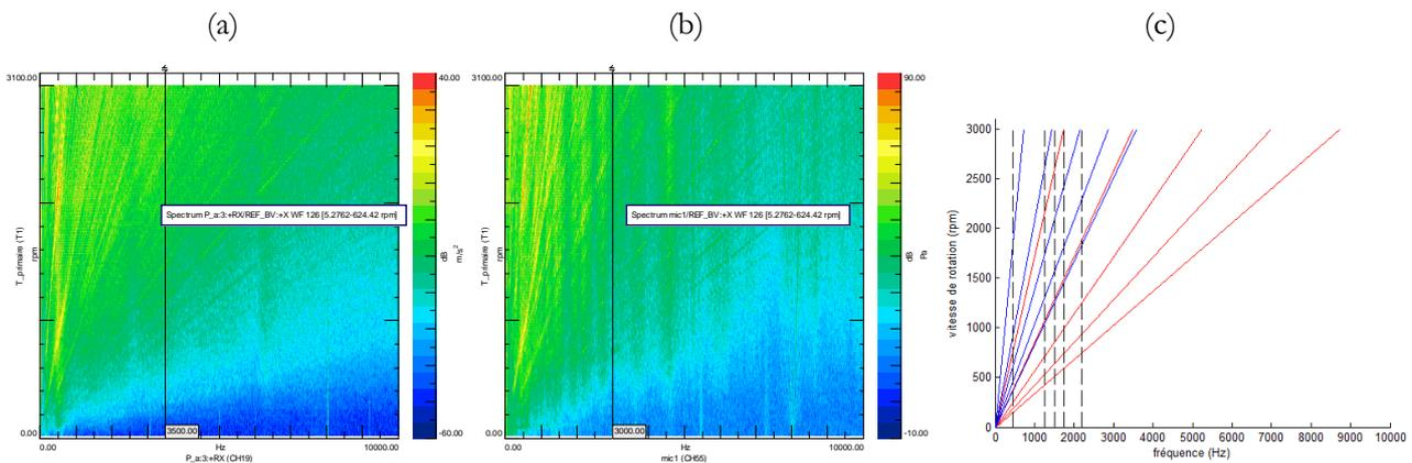
FIG. 5 – Waterfall pour un balayage vitesse de 100 à 3000 tr/min.
