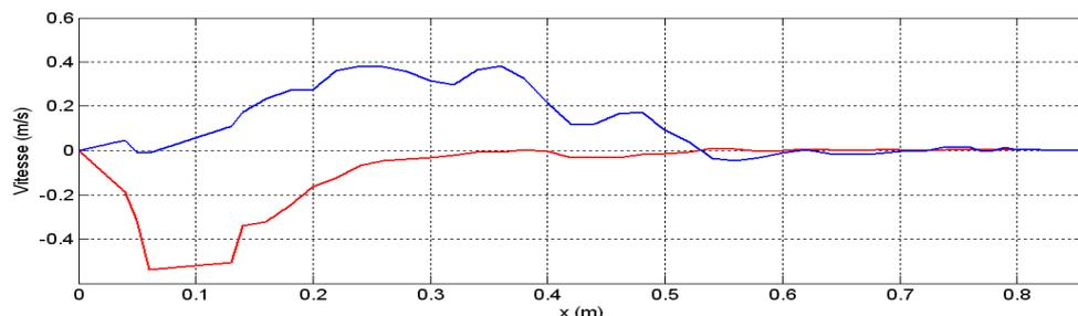
FIG. 4 – Vitesse initiale de la corde au lâcher selon  $x0y$  (bleu) et  $x0z$  (rouge).
