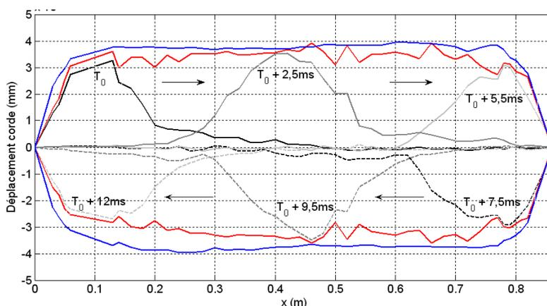
FIG. 6 – Noir et gris : déformations mesurées dans  $xOz$  à différents instants d'une période. Rouge : enveloppe vibratoire (mesure) =. Bleu : enveloppe vibratoire (calcul)
