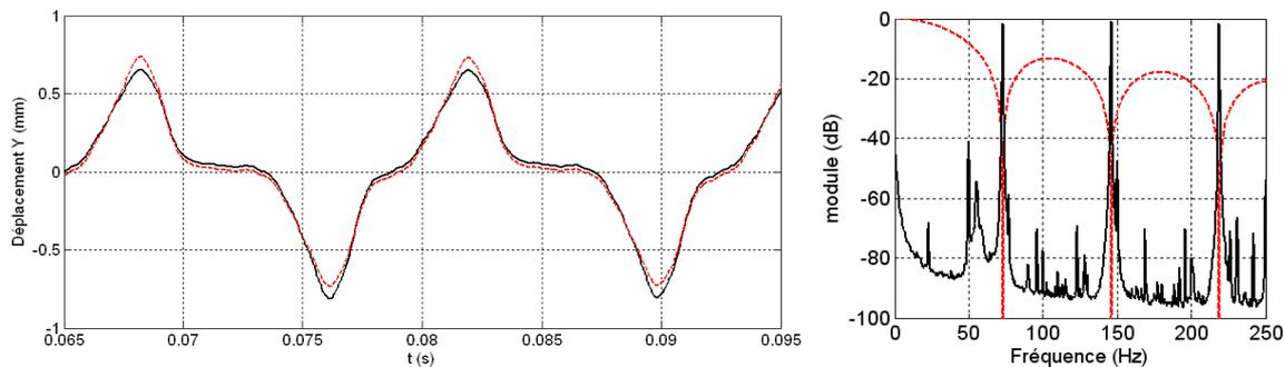
FIG. 2 – A gauche : effet de la correction de non linéarité du capteur sur le déplacement selon  $Y$  au centre de la corde, excitation plectre. Déplacement sans correction (noir plein) et avec correction (rouge pointillés). A droite : Transformée de Fourier d'un signal de vitesse (noir) et du filtre utilisé (rouge)
