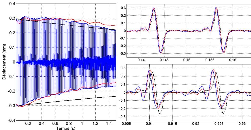
FIG. 5 –Déplacement à 8cm du sillet dans  $xOz$ . A gauche : Bleu : signal et enveloppe (expérimental). Noir : enveloppe (calcul sans raideur). Rouge : enveloppe (calcul avec raideur). A droite : Déplacement mesuré (bleu) calculé sans (noir) et avec (rouge) raideur, 150 ms (haut) et 900ms (bas) après le lâcher.
