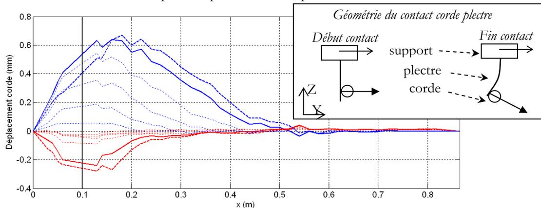
FIG. 3 – Déformation selon  $x0y$  (bleu) et  $x0z$  (rouge) pendant le contact corde-plectre (durée 3ms). Pointillés fins : pendant le contact toutes les 0,6ms, trait plein : au lâcher, tirets épais : 0,3ms après le lâcher. Trait noir vertical : position du plectre.
