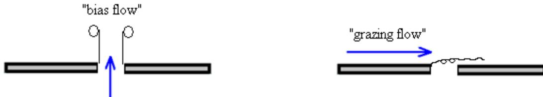
Fig. 2 : Les deux configurations génériques le plus souvent considérées pour établir les modèles d'impédance acoustique de parois multiperforées avec écoulement..
