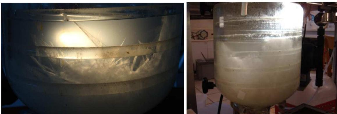
FIG. 4 : Aspect du dépôt solide : peu après le début de la cristallisation (à gauche) et en fin d'opération (à droite).
