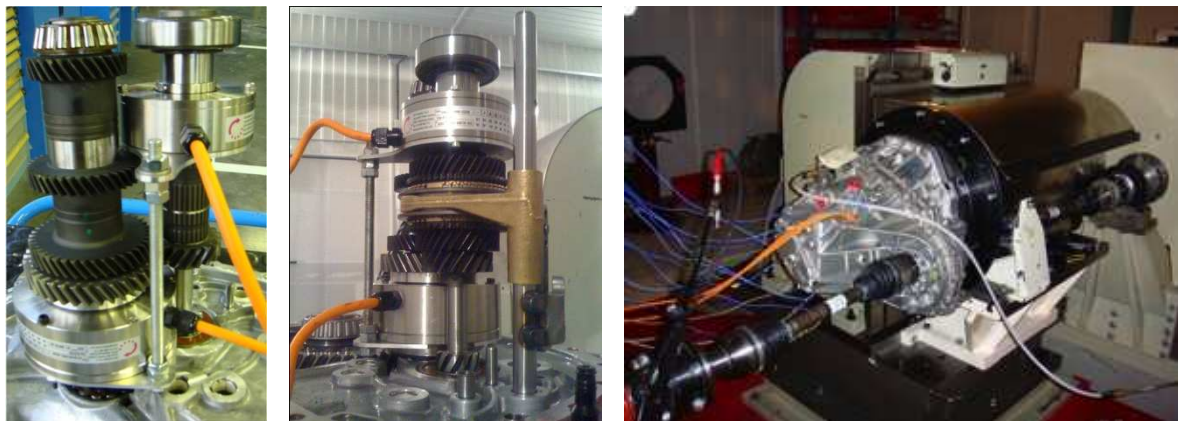
FIG. 1 – Lignes d'arbres instrumentées avec le pignon fou de 2 nde seul (a), + les pignons de 3 ème et 4 ème (b). Boîte de vitesses TL4 instrumentée montée sur le BACY (c).
