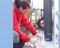
Echantillonnage pour l'oxygène dissous
