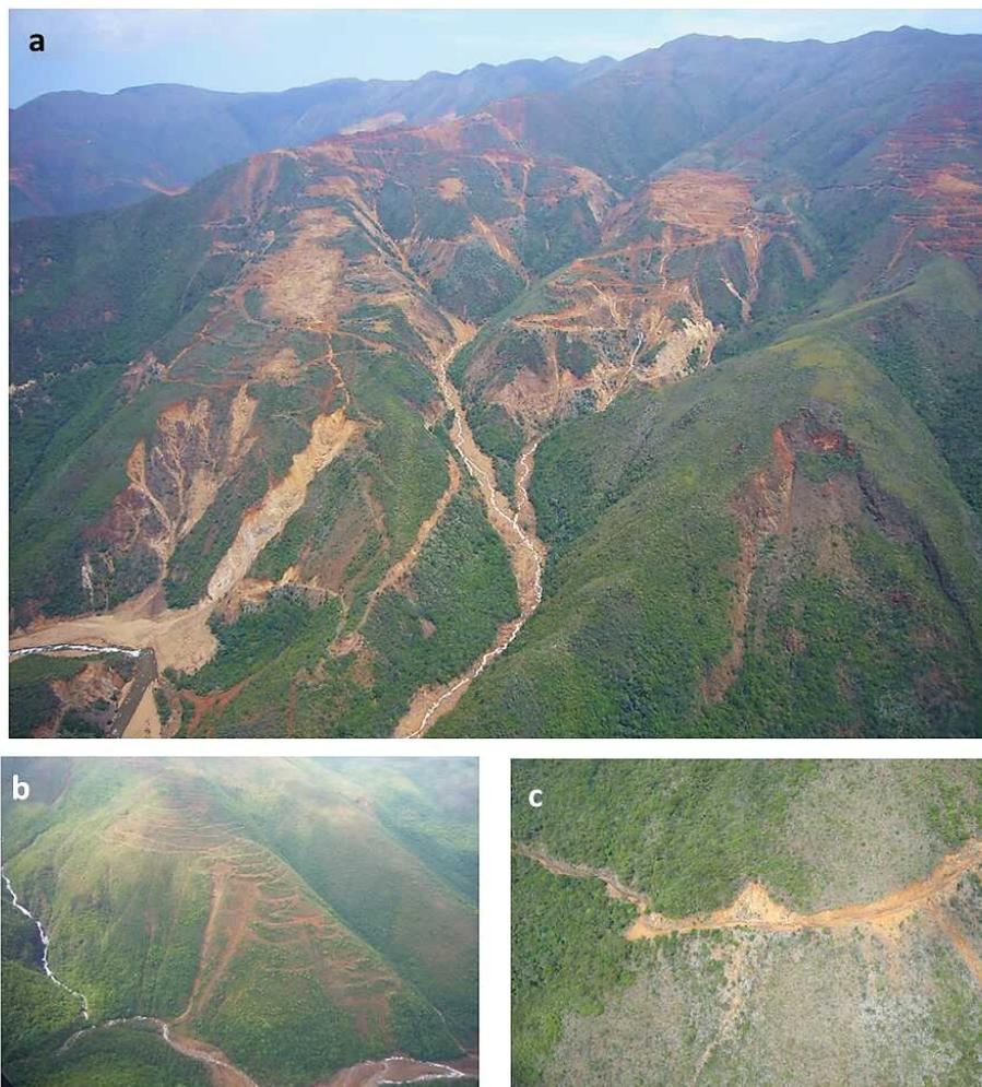
Figure 83 : a) Anciennes décharges, érosion en zone d'exploitation, érosion induites par les pistes, mouvement de terrain et sur-engravement des creeks en contre-bas (Hwa No); b et c) érosion liée aux pistes
