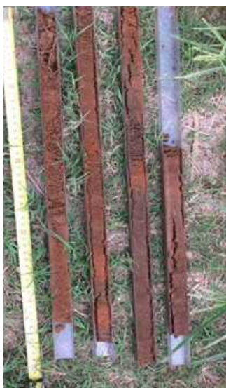
Figure 142 : Carotte sédimentaire prélevée en aval du bassin de la Thio
