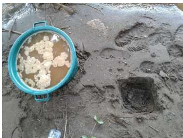
Figure 164 : Volume de 30x30x10 cm pour le prélèvement des échantillons + bassine remplie de 50L d'eau
