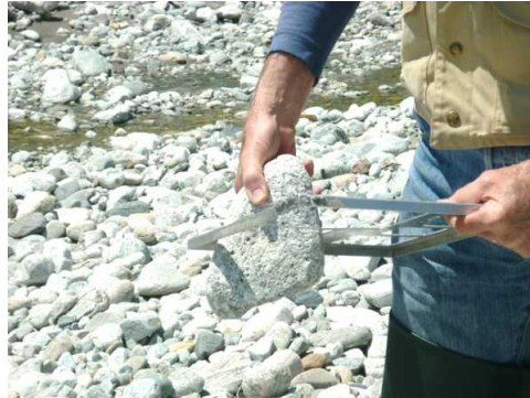
Figure 124 : Mesure de la granulométrie par la méthode Wolman
