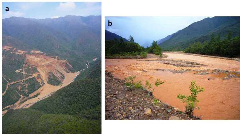
Figure 82 : a) cônes dans le creek Liliane en aval des décharges minières ; b) eaux rouges latéritiques lors d'un orage (Hwa No)
