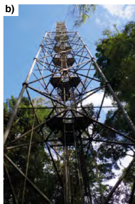
a) Expérimentation en serre pour tester l'influence de la sécheresse sur la résistance à la sécheresse des jeunes arbres en forêt tropicale humide. Crédit photo : Camille Ziegler. b) Tour à flux de 55 m de haut en Guyane destinée à mesurer les échanges de gaz entre l'écosystème et l'atmosphère. Crédit photo : Damien Bonal.
