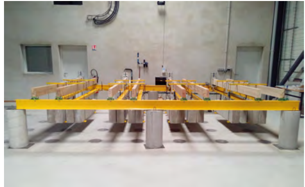
Banc de fluage en flexion (Egletons). Crédit photo : Maximin Varnier (GC2D).
