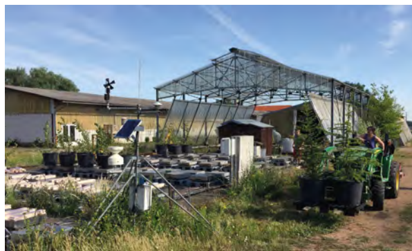
Mise en place d'une expérimentation sur la plateforme de phénotypage de la résistance à la sécheresse des arbres du site INRA de Crouël. Les arbres sont placés sur des balances sous un abri roulant et exposés à une sécheresse. Des panneaux radiants chauffants seront utilisés pour simuler une vague de chaleur. Crédit photo : H. Cochard.
