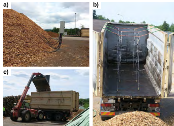
a) Tas statique de plaquettes forestières instrumenté. b) Benne de camion équipée de 12 antennes prototypes. c) Remplissage de la benne du camion pour une mesure.
