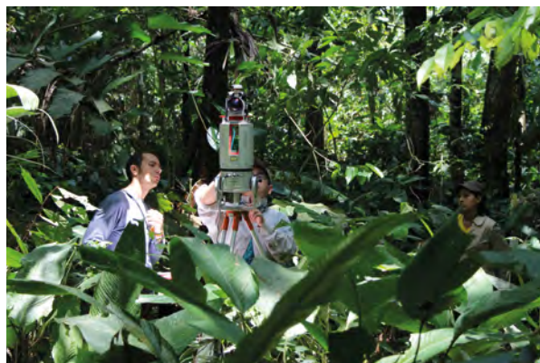
Mise en place d'un scanner terrestre LIDAR pour mesurer la structure des arbres de la forêt amazonienne péruvienne. Crédit photo : Alvaro Lau Sarmiento.
