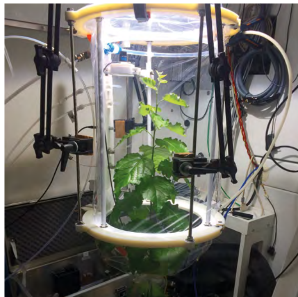
Jeune peuplier enfermé dans une chambre de piégeage des COVs lors des expérimentations du projet ODORSCAPE. Crédit et copyright : LSCE-EcoPhyS/iEES.
