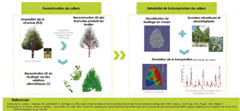
Méthodologie de simulation de l'effet rafraîchissant d'un arbre : de l'acquisition par Lidar terrestre à la simulation de la transpiration.
