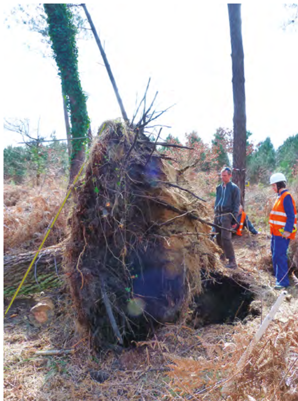
Mesure de l'ancrage des arbres par des essais de flexion in situ : système racinaire d'un pin maritime adulte (hauteur de l'arbre 26 m) après renversement. Crédit photo : D. Garrigou (INRA).
