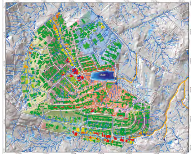
Vulnérabilité du bâti face au risque de ruissellement (faible en vert, importante en rouge). Quartier de Petite Place Cazeau - Commune de Delmas, Port-au-Prince. Crédit : SERTIT - KAL-Haïti.
