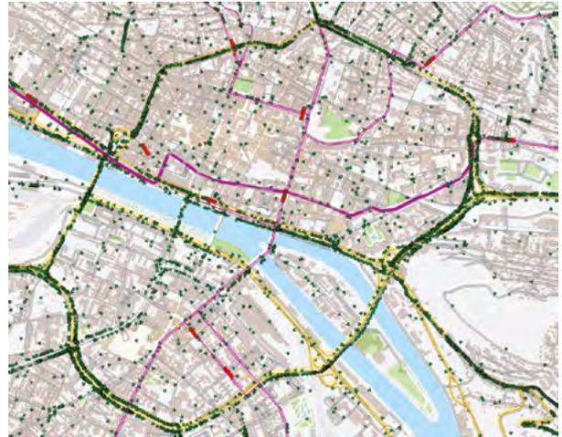
Simulation numérique du déplacement de voitures (verts) et d'autobus (rouges) sur le réseau routier de l'agglomération rouennaise. La calibration du modèle à partir d'enquêtes ménages déplacements et la comparaison des résultats de simulations avec des données de trafic observés permet de valider le modèle.
