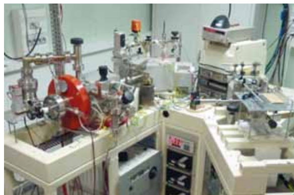
Spectromètre de masse permettant de concentrer les isotopes radioactifs 81 Kr et le 85 Kr du krypton. Les atomes de Kr sont implantés dans des feuilles d'aluminium et libérés sélectivement sous vide à l'aide d'un laser infrarouge.
