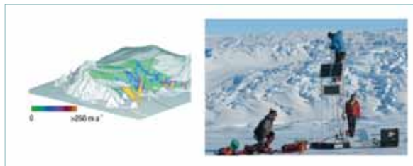
Illustration du processus de concentration de la glace dans son cheminement vers la mer pour former un système émissaire étroit à fortes vitesses d'écoulement à la côte, à l'image d'un fleuve (figure de gauche). Montage d'une des 9 stations GPS permanentes et autonomes du réseau de déformation du glacier école de l'Astrolabe en Terre Adélie (figure de droite).
