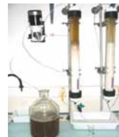
Fractionnement de la matière organique dissoute par passage de l'échantillon sur des résines chromatographiques.
