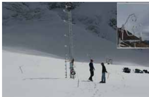
Dispositif de mesure des fluctuations turbulentes, des profils de température et de vent sur le glacier Zongo situé en Bolivie à 5 050 m d'altitude.
