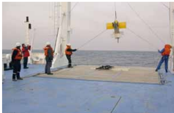
Déploiement du Seasoar (poisson remorqué permettant l'acquisition en continu de profils verticaux de température et de salinité) à bord du bâtiment hydro-océanographique « Beautemps-Beaupré » (campagne EPIGRAM/MOUTON 2009).
