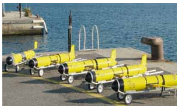
Une partie du Parc National de Gliders opéré par la Division Technique de l'INSU/CNRS. Il s'agit ici de cinq gliders de type SLOCUM.
