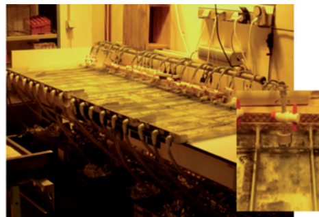
Canaux expérimentaux utilisés pour les expérimentations sur les communautés microbiennes des rivières - © : IRSTEA Lyon
