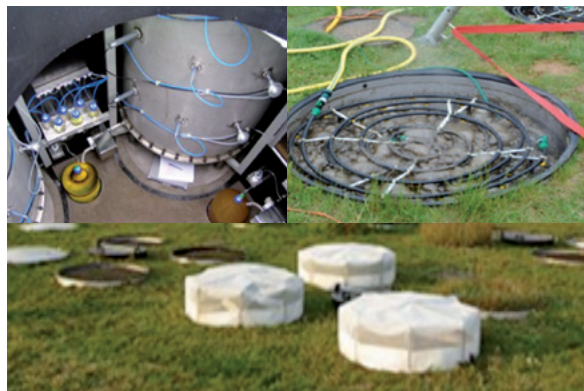
Essais d'oxydation in situ en dispositif lysimétrique avec la réaction de Fenton sur un sol issu d'une ancienne cokerie (de gauche à droite, la station lysimétrique du GISFI, un lysimètre et une image de l'alimentation en oxydant lors de la campagne menée en juin 2010)
