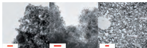
Structure interne de 3 matériaux synthétisés par différentes méthodes illustrant les nanopores dans lesquels sont piégés les biomolécules actives (barre d'échelle : 100 nm)
