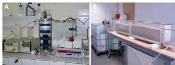
Dispositifs expérimentaux pour l'étude du transfert de suspensions de nanoparticules A) à travers une colonne de roche en appliquant une contre pression, et B) sous gradient hydraulique dans un pilote rempli de sable
