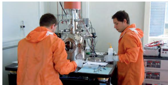
Prototype de l'outil « CryoFIB » en cours de finalisation au Laboratoire de Photonique et de Nanostructures. Sur cet outil sont intégrés une tête à 4 Kelvin (Institut Néel), une source d'ions He/Ar de taille atomique (LPMCN Lyon) et une plate-forme dédiée UHV (Orsay Physics S.A.).
