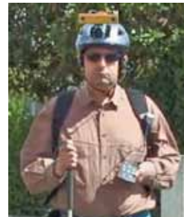
Prototype NAVIG incluant un récepteur GPS avec une centrale inertielle à la hanche, et une caméra stéréoscopique avec un dispositif de suivi du mouvement montés sur la tête. Un microphone et un casque par conduction osseuse ont été ajoutés pour l'interaction en entrée et sortie. Dans ce prototype, un ordinateur portable est logé dans un sac à dos.
