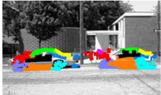
Résultats des détections d'objets avec un modèle hiérarchique (Kokkinos and Yuille, 2011) ; la tâche de la détection entraîne l'identification des structures de l'image qui constituent l'objet, et résoudre la détection simultanément avec la segmentation.
