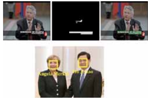
Exemples de segmentation des sous-titres (au dessus) et des visages (en dessous) pour l'identification des personnes dans des enregistrements audiovisuels.
