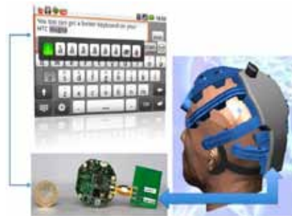
Projection du prototype BCI pour la communication présentant les interactions entre les composants mécaniques, électroniques et informatiques.
