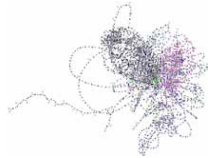
Un exemple de « graphe d'implication », représentant des dépendances entre variables conduisant à un conflit. L'analyse de ce graphe d'implication, exécuté plusieurs milliers de fois par seconde, est l'un des éléments clés de la puissance des solveurs SAT dit « modernes ».
