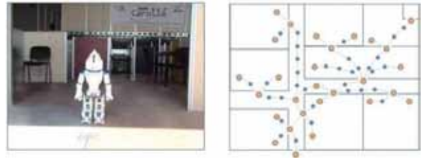
Le robot Nao devant le défi Carotte et l'arbre topologique construit pendant l'exploration et utilisé pour la navigation.
