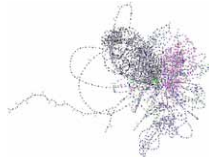
Un exemple de « graphe d'implication », représentant des dépendances entre variables conduisant à un conflit. L'analyse de ce graphe d'implication, exécuté plusieurs milliers de fois par seconde, est l'un des éléments clés de la puissance des solveurs SAT dit « modernes ».
