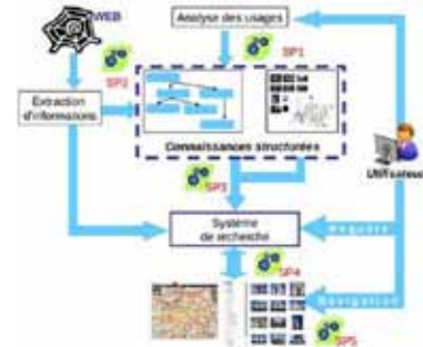
Structure du projet Georama : passage de ressources hétérogènes disponibles sur le Web vers des connaissances géographiques et usage de ces connaissances dans un système de recherche d'images.
