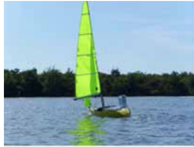
Plate-forme expérimentale « robuBoat » développée à partir d'une coque de voilier Mini-J.
