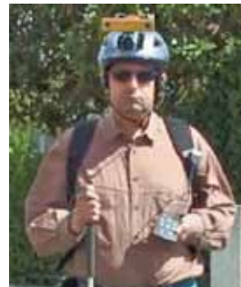
Prototype NAVIG incluant un récepteur GPS avec une centrale inertielle à la hanche, et une caméra stéréoscopique avec un dispositif de suivi du mouvement montés sur la tête. Un microphone et un casque par conduction osseuse ont été ajoutés pour l'interaction en entrée et sortie. Dans ce prototype, un ordinateur portable est logé dans un sac à dos.
