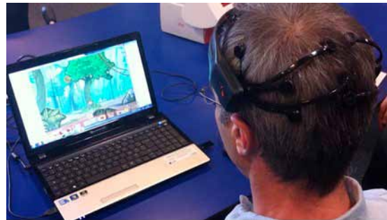
OpenViBE2 étudie l'utilisation des interfaces cerveau-ordinateur pour les jeux vidéo : ici, à l'aide d'un casque à électrodes, un joueur « tire par la pensée » sur des cibles virtuelles.
