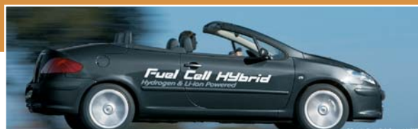
Véhicule FISYPAC réalisé durant le projet, construit sur une plateforme Peugeot 307CC (Vitesse maximale de 155 km/h - Autonomie sur batterie de 75 km ou 450 km en fonctionnement hybride)
