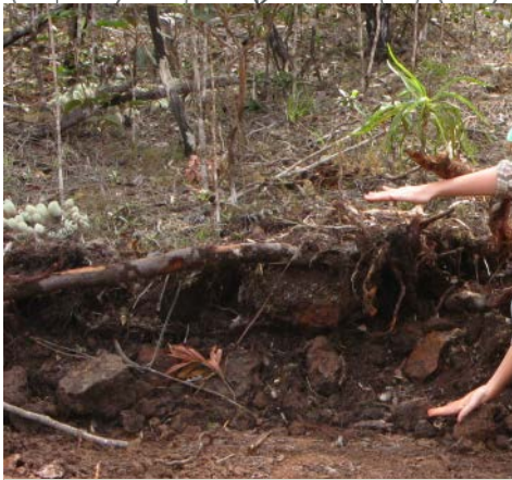
Figure 9 : Exemple de plan de prospection adapté à la topographie d'une zone à décaper pour l'évaluation des épaisseurs de topsoil et latérite rouge à récupérer (Illustration Pierre Loslier), et photo d'un profil montrant les limites entre les horizons de topsoil et latérite rouge (©iac).
