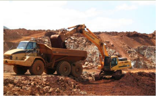
Figure 11 : Illustrations des étapes de défrichage, mise en andain et chargement des substrats récupérés lors du décapage (topsoil).
