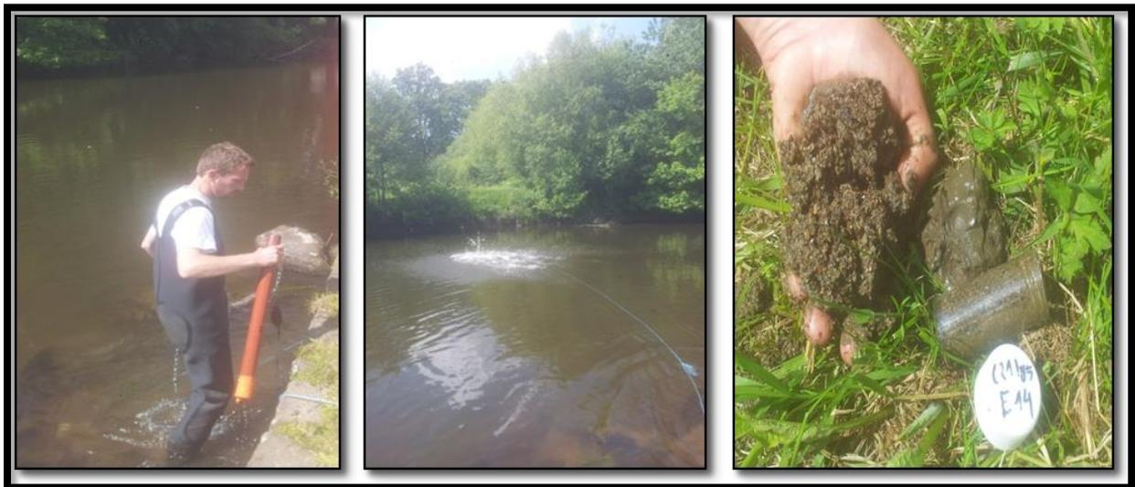
Figure 21 : A gauche, drague utilisée pour l'échantillonnage ; au milieu, lancé de la drague au milieu de la section ; à droite, sous échantillonnage des sédiments collectés
