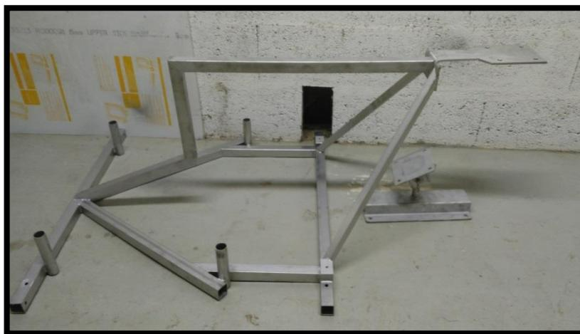
**Figure 26 : Structure porteuse en inox pour l'UB-Flow**
