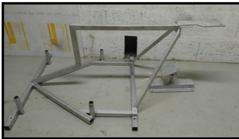
Figure 26 : Structure porteuse en inox pour l'UB-Flow
