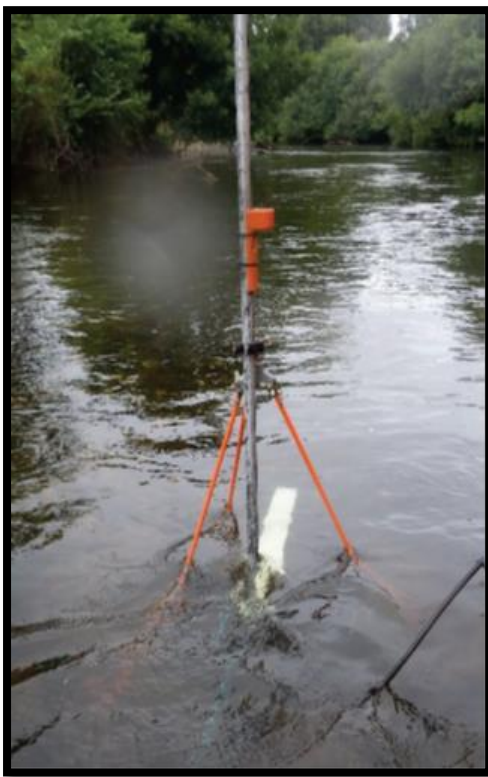
Figure 25 : UB-Flow en rivière. La nécessité d'effectuer des enregistrements de plusieurs minutes, implique l'utilisation d'un support stable pour maintenir l'horizontalité de l'appareil
