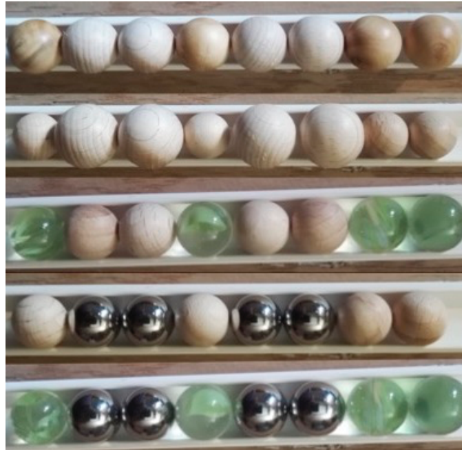
Figure 1. Variantes de matériaux pour les bits. De haut en bas : buis et hêtre 15mm, hêtre 15 et 20mm, verre 16mm et buis 15mm, hêtre et acier 15mm, verre 16mm et acier 15mm
