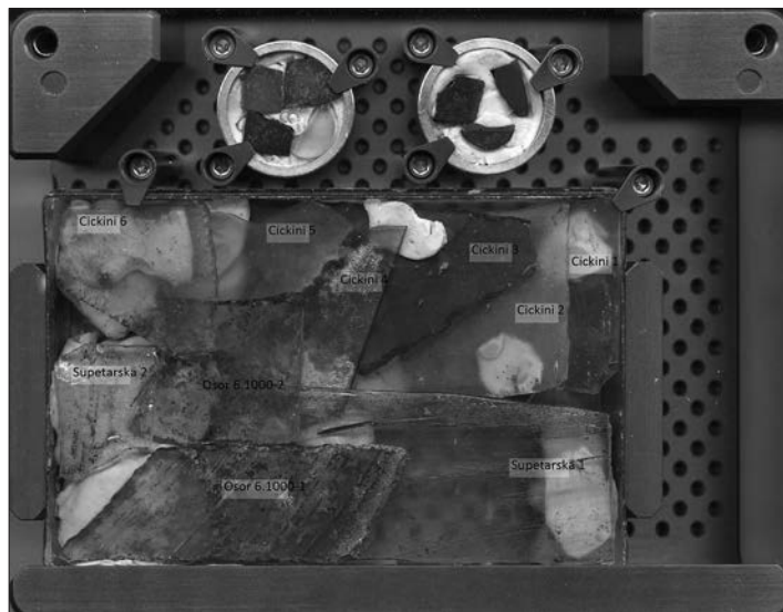
2. - Cellule d'analyse avec une partie des verres plats croates analysés.
