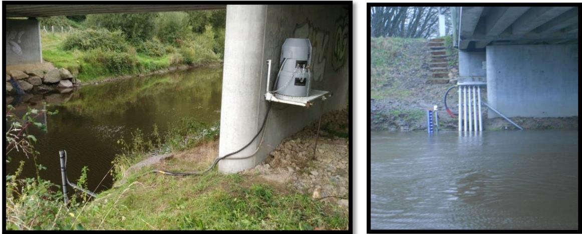
Figure 4 : Station amont (EDF-INRA), à gauche : le préleveur installé par l'INRA, À droite : Les sondes et le dispositif de suivi installés par EDF
