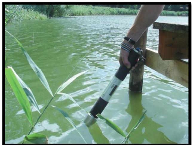
Figure 3 : Photo de la sonde optique permettant de mesurer la chlorophylle a (source : Société Bionef)
