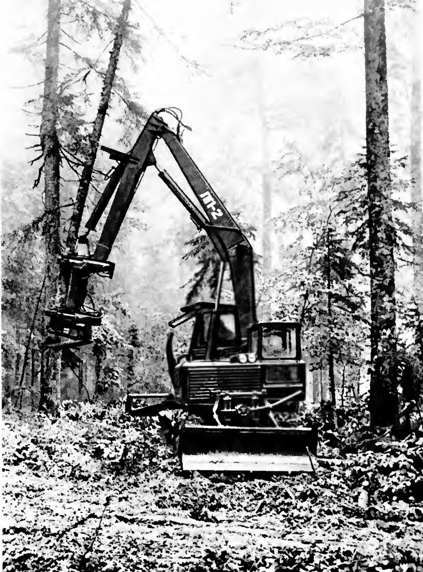
La "Diatec LP 2" au travail : après rotation, l'arbre sectionné à sa base va être disposé horizontalement sur les crochets à gauche de la machine ; c'est un "feller-buncher" Photo RAGOT
