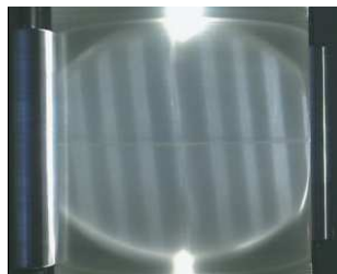
FIG. 6 – Zones de cisaillement axisymétriques excitées par les marées dans le cas d'un forçage incliné d'environ 5^\circ par rapport à l'axe de rotation (Ekman de 10^{-5} ).
