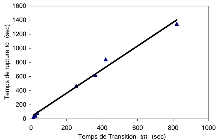
FIG.8 – Corrélation entre la durée du fluage primaire  $t_m$  et le temps à rupture  $t_c$ .
