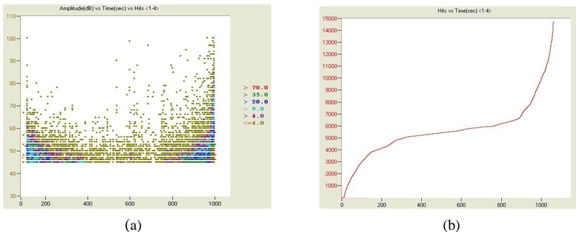
FIG.4 – Evolution de l'activité acoustique au cours d'un essai de fluage :
