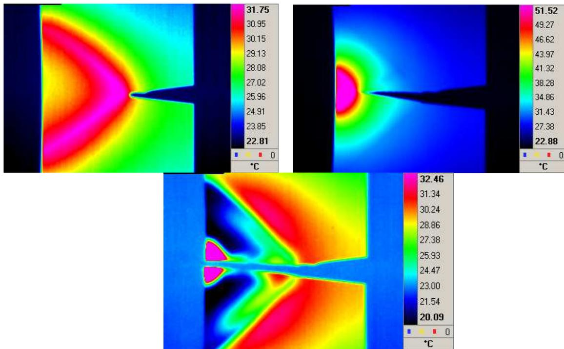
Figure 6 : Champ de température avant la rupture
