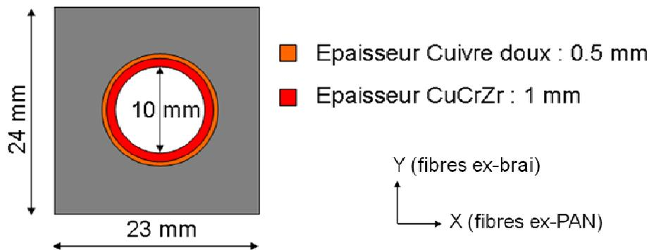
FIG. 1 – Dimensions d'un monobloc.
