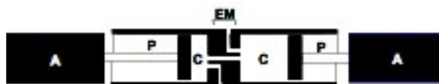
FIG. 1 – A actionneurs ; P pistons ; C chambres de mélange ; EM élément de mélange.
