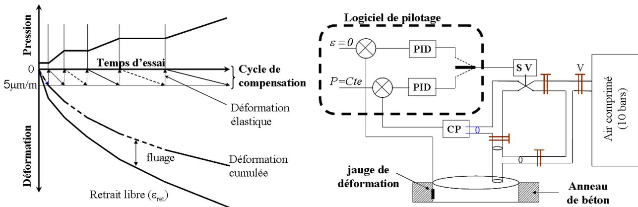
FIG. 3 – Schéma de principe du pilotage de l'essai de retrait empêché.
