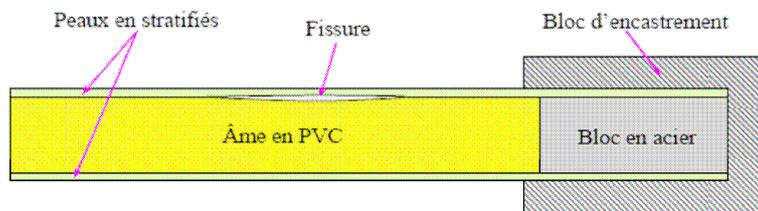
FIG 3. Schéma d'un bloc d'encastrement d'une poutre sandwich
