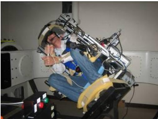
FIG. 2 – Chaise d'orientation multi-axiale - Ashton Graybiel Spatial Orientation Lab à Boston [1]
