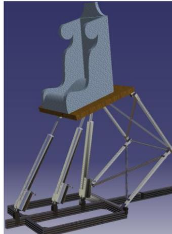
FIG. 7 – Modèle numérique de l'interface sous CATIA
