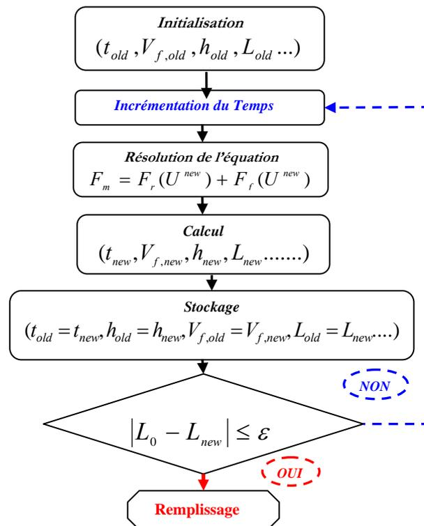
FIG. 4 –Algorithme de calcul du temps de remplissage
