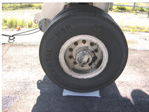
FIG. 7 – Mise en place du film Fuji entre les pneumatiques de la monte jumelée et le revêtement
